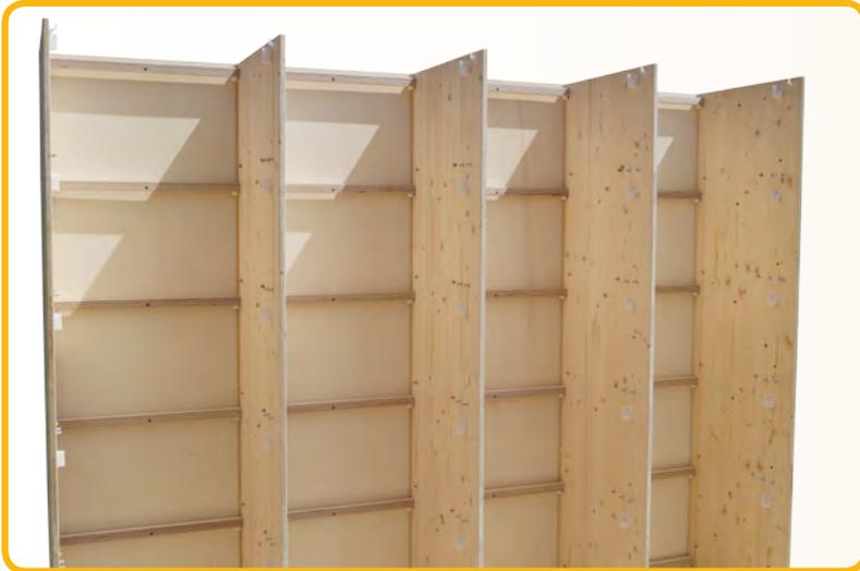
Fall der Schrank mit Rückwand geliefert wird, die Rückwände in die Nutleiste hinten an den Seiten stecken. Dann die hinteren Querleisten mit dem Maß 19 x 27 mm von oben nach unten auf die Metallbolzen an den Seitenwänden aufstecken. Insgesamt 5 Leisten.
