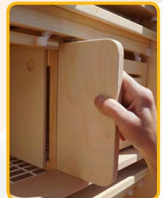
Das Trennstück einbauen. Der Dübel mit der Metallfeder wird oben in die Bohrung der Querleiste gesteckt und hochgedrückt. Dann vorsichtig das Trennstück zur Seite schieben bis dieses unten in den beiden Bohrungen der Sitzleiste einrastet.
